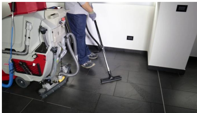
Aspiration de la solution avec lance extensible
