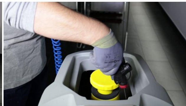
Nettoyage du réservoir de récupération avec pistolet dédié
